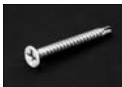
Tornillos para elevador de umbral #6 – 1-1/4" x 30 Cabeza plana Phillips blanca autopercutor
